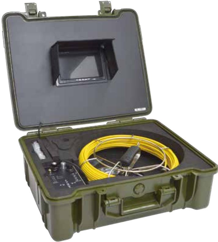
カメラ先端部はバネが入っており曲げる事の出来る最小半径は90度の直角配管で50mm幅があれば進めます
